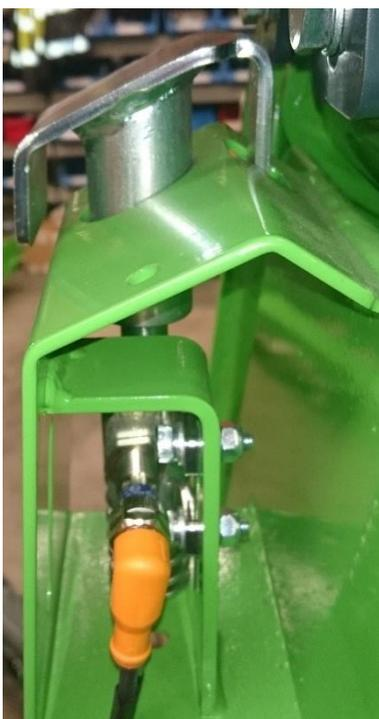
Bild 23. Der oberer Sensor der Transportstütze
