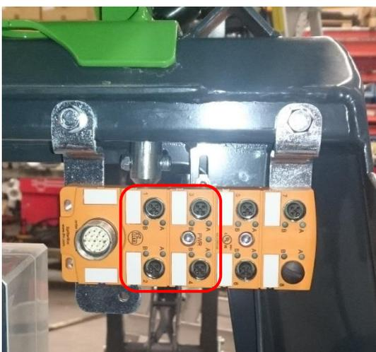
Bild 18. Verteilerdose, Stützauslegerverbinder innerhalb des roten Quadrats
