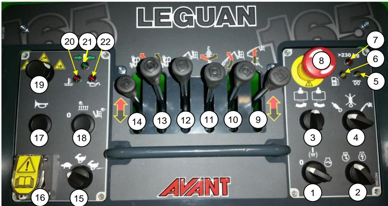
Imagen 5. Palancas, conmutadores y botones del panel de control superior
