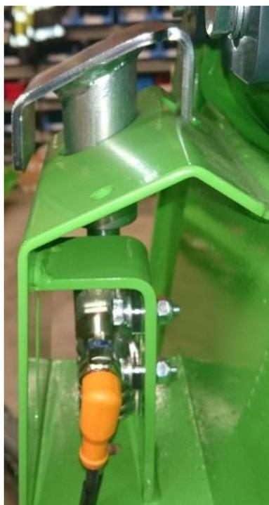
Imagen 23. Sensor del soporte de transporte superior
