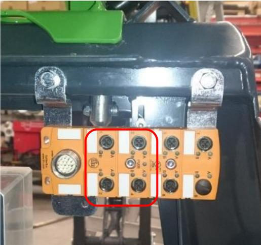
Imagen 18. Caja distribuidora, conectores de puntal marcados dentro de recuadro rojo
