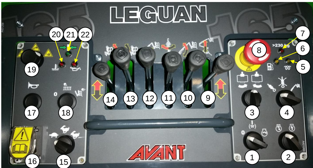
Figur 5. Spaker, brytere og knapper på øvre kontrollpanel
