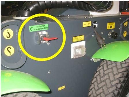
Der Batteriehaupschalter sorgt dafür, dass der +Pol der Batterie komplett von der elektrischen Anlage der Hubarbeitsbühne getrennt wird, sobald man den Batteriehaupschalterschlüssel entfernt. Wenn der Hauptstrom ausgeschaltet wird, sind alle Funktionen mit Steuerströmen ausgeschaltet, ausgenommen der Notablass. Schalten Sie den Batteriehaupschalter nicht aus, wenn die Hubarme angehoben sind! Das Batterieladegerät lädt die Batterie auch, wenn der Hauptschalter ausgeschaltet ist.
