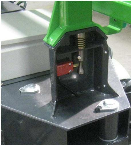
Der Sensor S8 (Endschalter) der Transportstellung befindet sich in der vorderen Transportauflage auf dem Untergestell. Siehe Bild links (Deckel der Transportauflage ist entfernt worden).
