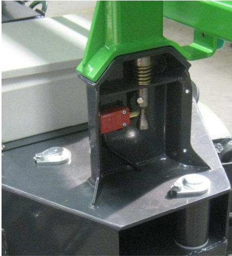
Le capteur S8 de la position transport est monté dans le support du bras qui se trouve dans la partie avant du châssis. Voir photo à gauche.
