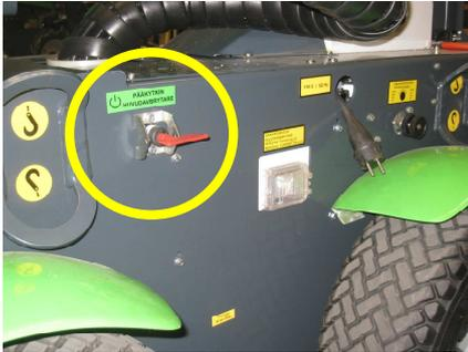
Le contacteur coupe-batterie connecte et coupe le circuit de la borne + de la batterie. Quand il est en position OFF, toutes les fonctions de basse tension sont coupées, à l'exception de la descente de secours. NE JAMAIS mettre la clé coupe-batterie en OFF quand les bras sont levés! L'enlever uniquement quand les bras sont en position transport.
