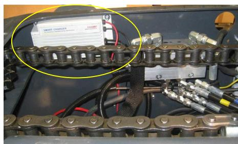
1. Le câble de branchement 230V 50Hz, 16A se trouve soit au côté du châssis soit à l'arrière à côté du moteur électrique.
