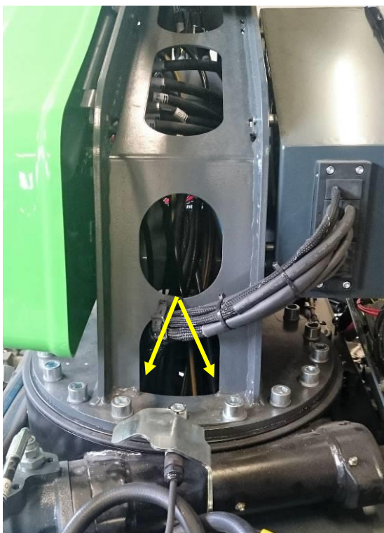
Schmierung der Schmiernippel durch die Öffnung am Drehturm, Bild von vorne.
