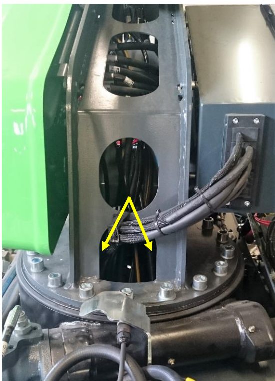
Kääntökehän voitelu pilarin aukon läpi (2 rasvanippaa), kuvattu edestä.
