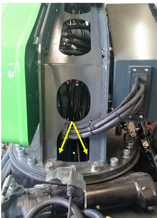
Smörjning av svänglager genom öppningen i piedestalen (2 smörjnippel), bild från front.
