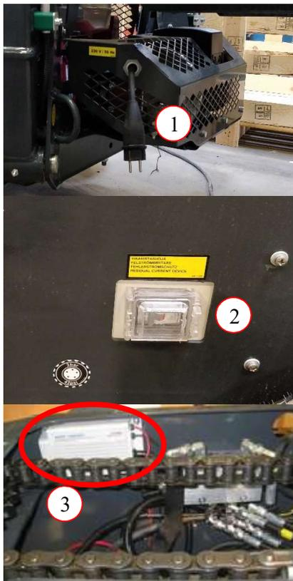
1. Câble de branchement de 230 V 50 Hz, 16 A, sortie sur le côté ou à l'arrière (modèle à moteur électrique)
