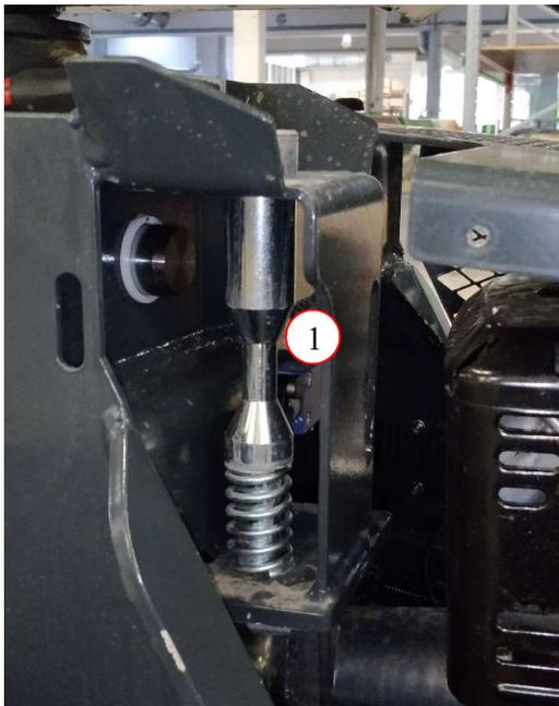
Le capteur de position de transport S8 (1) est situé entre le moteur à combustion et le châssis. La protection en plastique du support de transport du bras doit être réglé de sorte à offrir un support suffisant sans placer trop de contrainte sur les bras.
