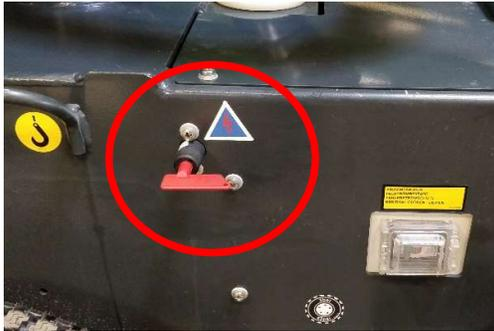
Utiliser le commutateur d'alimentation principal débranche le circuit d'alimentation de la borne positive de la batterie. Hormis pour la descente de secours et le tracker GPS (accessoire en option), les fonctions de basse tension sont désactivées quand l'alimentation est éteinte. **NE JAMAIS** couper l'alimentation principale si les bras ne sont pas en position transport !
