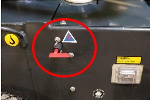
Mit dem Hauptschalter wird der Stromkreis des Pluspols der Batterie unterbrochen. Mit Ausnahme der Notabsenkung und des GPS-Trackers (optionales Zubehör) sind die Niederspannungsfunktionen bei ausgeschalteter Stromversorgung deaktiviert. Schalten Sie den Strom NICHT aus, wenn sich die Ausleger nicht in Transportstellung befinden!
