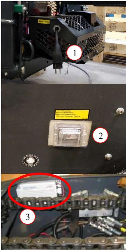
1. 230 V 50 Hz, 16 A Anschlusskabel, Ausgang wahlweise seitlich oder hinten (Elektromotor)
