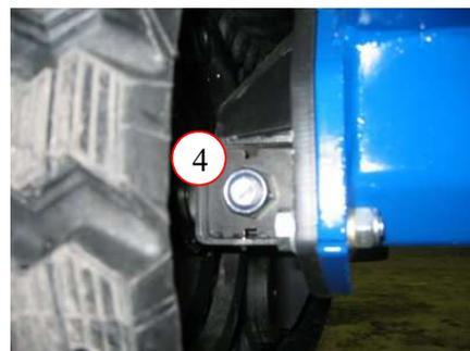
Inspeccionar la estanqueidad de las orugas:
