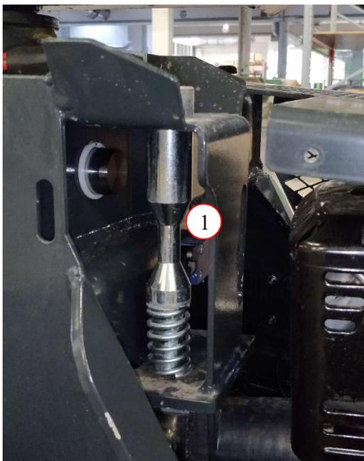
El sensor de posición de transporte S8 (1) se encuentra entre el motor de combustión y el chasis. La protección de plástico del soporte de transporte del brazo debe ajustarse de tal manera que ofrezca suficiente soporte sin ejercer demasiada presión sobre los brazos.
