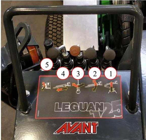
1. 1.<sup>a</sup> palanca de control del brazo
