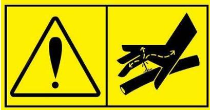
No manipule componentes hidráulicos presurizados, ya que en caso de fallo de un accesorio o componente, una pulverización de aceite hidráulico de alta presión puede provocar el vuelco de la máquina y provocar lesiones graves. No ponga en marcha la máquina si ha notado fallos en el sistema hidráulico.
