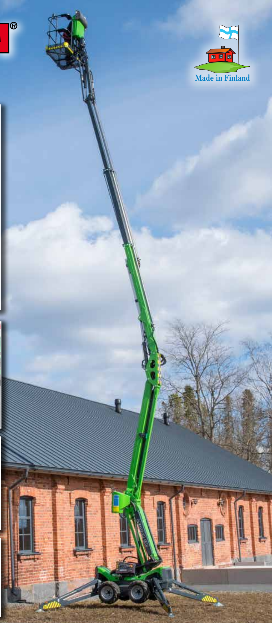
Från korgen styr man allt via en panel med automatisk nivellering och automatisk växellåda för körning, max. Körhastighet 5,2 km/h
