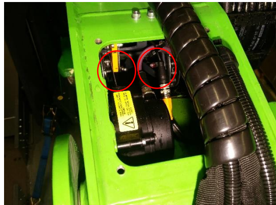
Figure 17 : Points de graissage de la poulie des chaînes à mailles jointives côté avant du 2 e bras.
