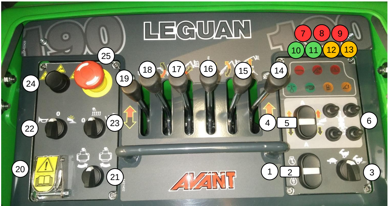
Afbeelding 5: Hendels, schakelaars en toetsen van het bovenste bedieningspaneel
