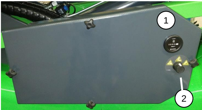
Afbeelding 9: Nooddaalsysteem op grondniveau
