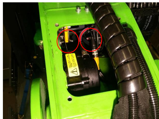
Afbeelding 17: Smeerpunten schijf van de schalmkettingen aan de voorkant van de 2 e arm.
