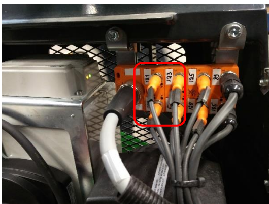
Afbeelding 24: Verdeeldoos, stempelconnectors gemarkeerd in rood vierkant
