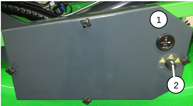
Figur 6: Nødsænkningsskninger på maskinen ved jorden
