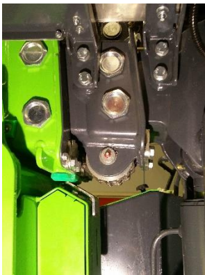
Figur 16: Smørenippel til teleskopkædens remskive
