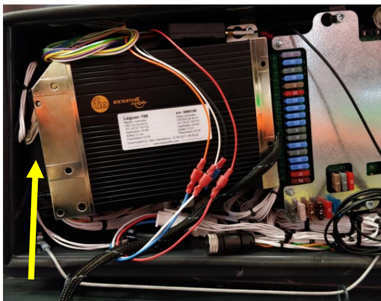
Figure 35 Kontakter til styreenhederne (2 stk.)
