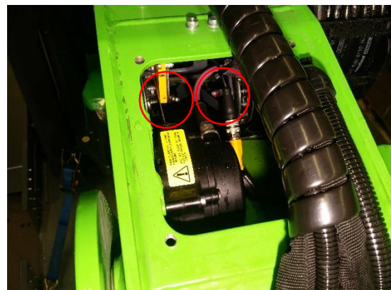
Figur 17: Smørepunkter for bladkædens remskive på forsiden af 2. bom.
