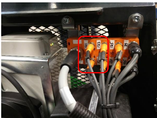
Figur 25: Splitterboks, stik til støtteben er markeret inde i den røde firkant
