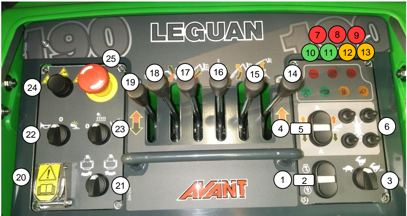
Figura 5: Palancas, interruptores y botones del panel de control superior
