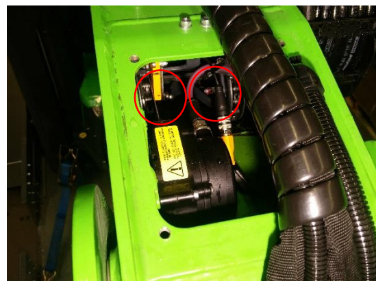
Figura 17: Puntos de engrase de la polea de cadena de la hoja en la parte delantera del 2º brazo.
