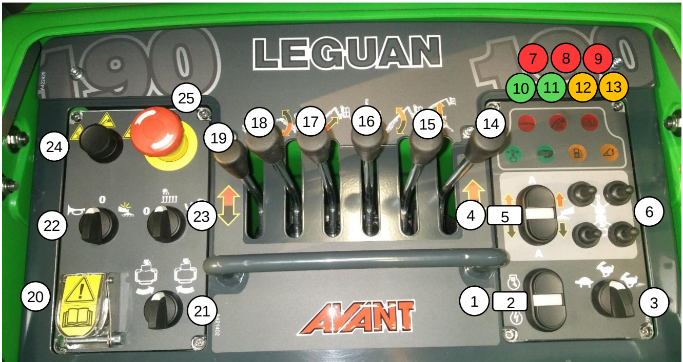
Figur 5: Spaker, brytere og knapper på øvre kontrollpanel
