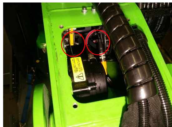
Figur 17: Bladkjedetrinsens smørepunkter på forsiden av den andre bommen.
