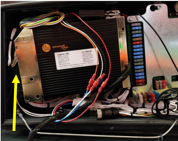
Illustration 34 Den logiska styrenhetens kontakter (2 st)
