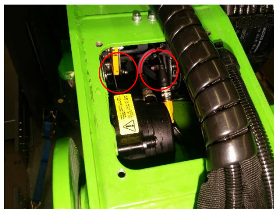
Illustration 17: Smörjpunkter till flyerkedjans remskivor på andrabommens framsida.
