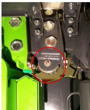
Illustration 16: Smörjnippel för remskiva
