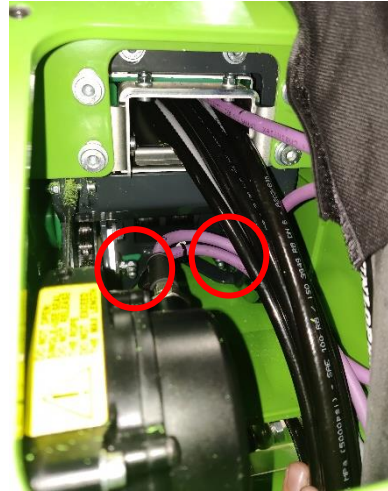
Abbildung 23. Schmierstellen für die Teleskopketten-Riemenscheiben am unteren und oberen Ende des Ausleger-Verbindungsstücks
