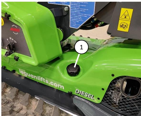
Figura 25. Tapón del depósito de combustible
