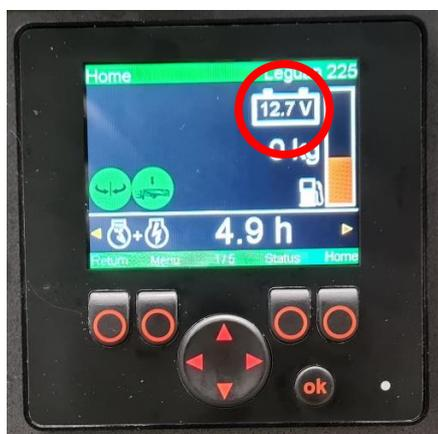
Figura 45. Tensión de la batería en la pantalla
