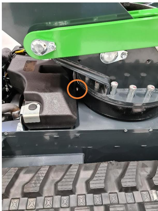
Figura 21. Tornillo de alivio de presión de lubricación de la corona giratoria
