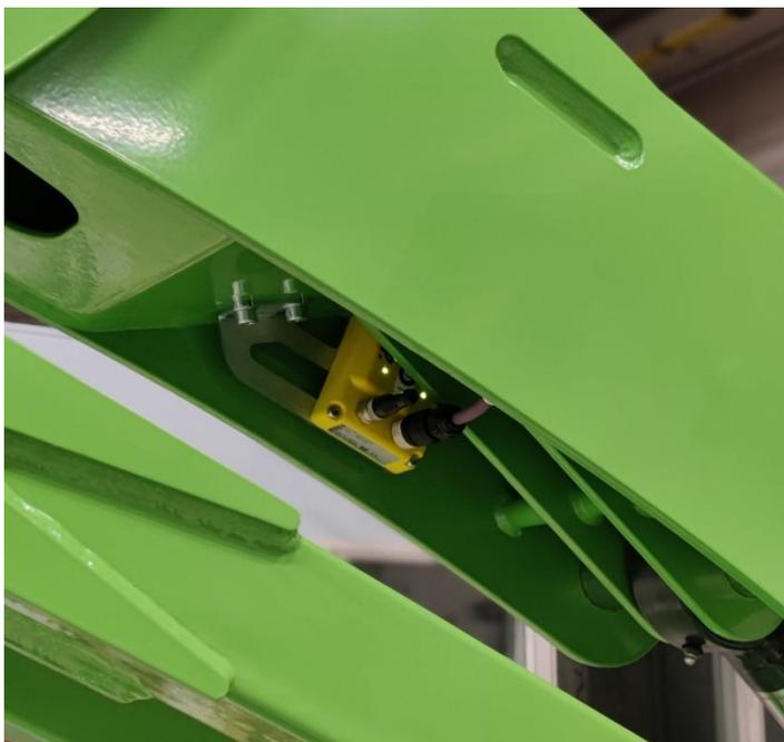
Figura 37. Sensor de posición de la pluma inferior
