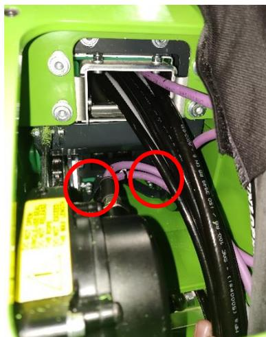
Figura 23. Puntos de lubricación de la rueda de la polea de cadena de la pluma telescópica en el extremo inferior y superior de la pieza de conexión de la pluma
