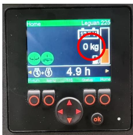
Figura 36. Carga de la plataforma de trabajo en la pantalla
