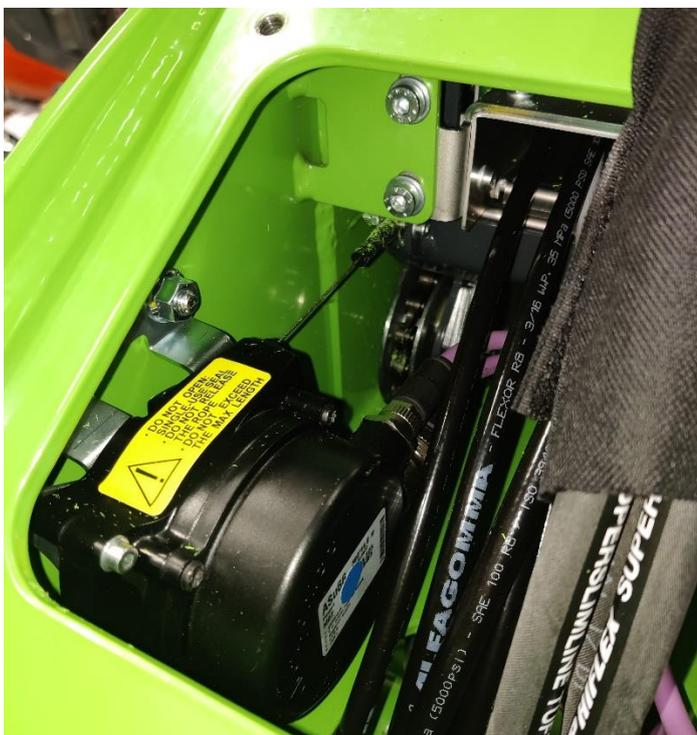
Figura 38. Sensor de posición de la pluma superior
