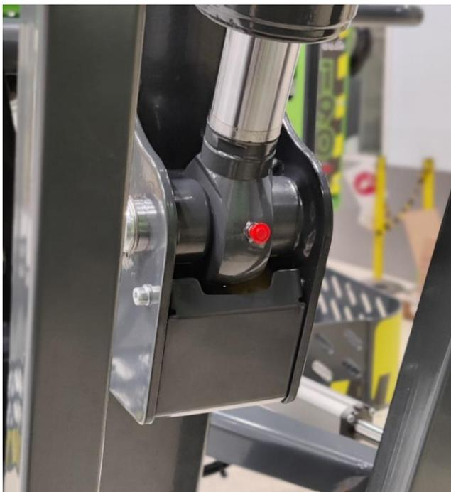
Figura 39. Sensor de posición del brazo de la pluma
