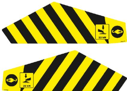
1. Fuerza estabilizadora y puntos de elevación
