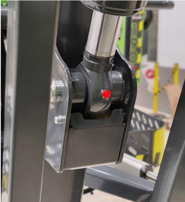
Figure 39. Capteur de position du bras pendulaire
