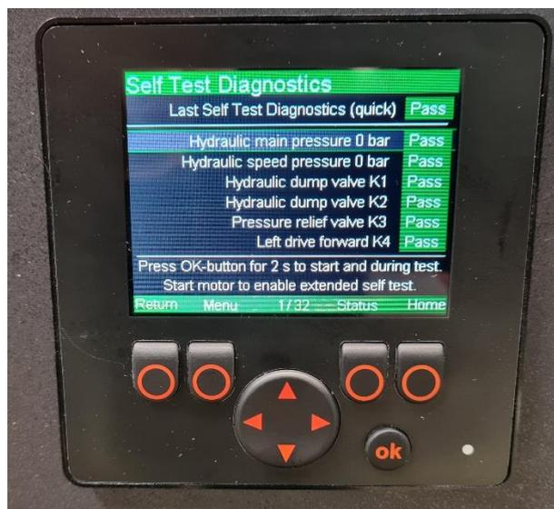
Figure 41. Sélection de « Diagnostic par autotest »
