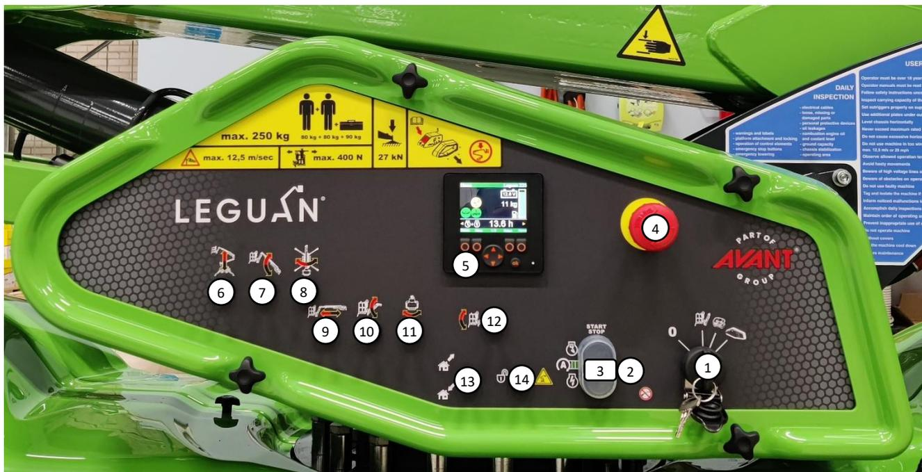
Figure 8. Panneau de commande inférieur
