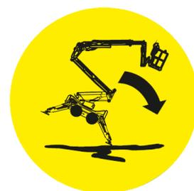
Si l'alarme d'inclinaison est déclenchée durant les fonctions d'entraînement, déplacez la machine sur une surface plus plane.
