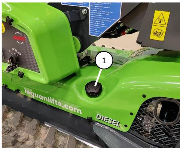
Figure 25. Bouchon du réservoir de carburant
