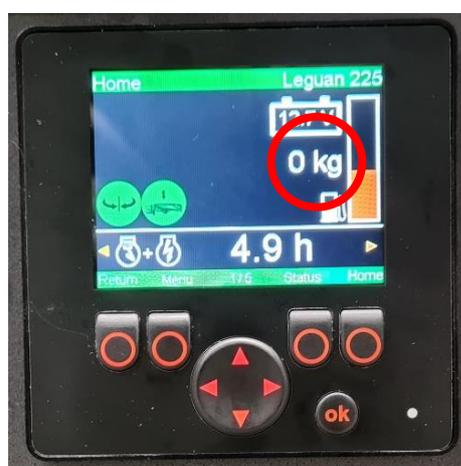
Figure 36. Charge de la plateforme à l'écran
