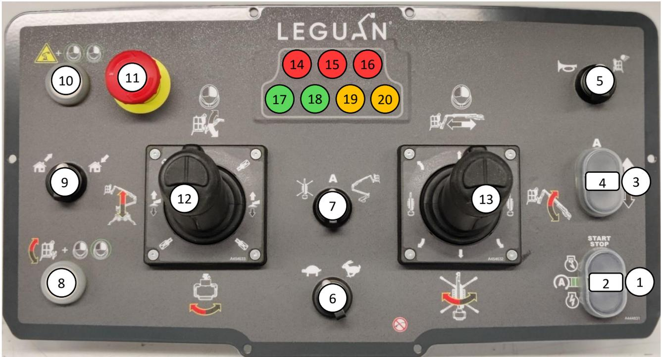
Figure 7. Panneau de commande de la plateforme
