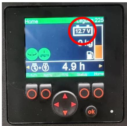
Figure 45. Tension de la batterie à l'écran
