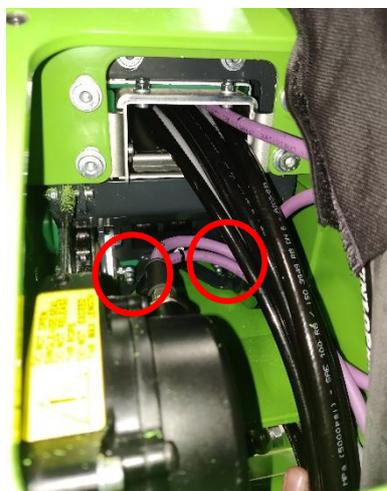
Figura 23. Punti di lubrificazione delle pulegge delle catene per il movimento telescopico all'estremità dell'elemento di collegamento dei bracci inferiore e superiore
