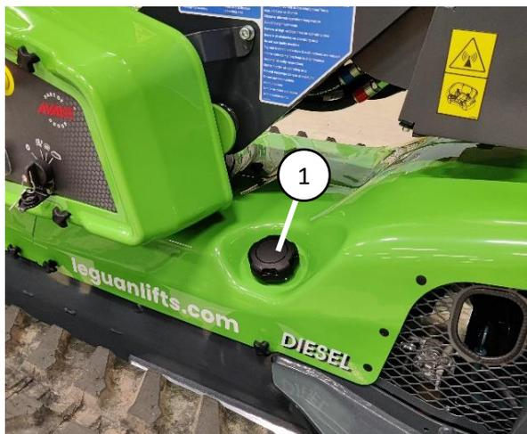
Figura 25. Tappo del serbatoio del carburante
