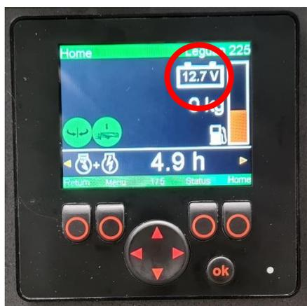
Figura 45. Tensione della batteria sul display
