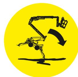
Se l'allarme di inclinazione viene attivato durante le funzioni di guida, spostare la macchina su una superficie più uniforme.
