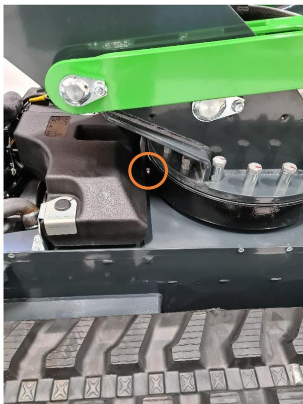
Figura 21. Vite di scarico della pressione di lubrificazione della ralla
