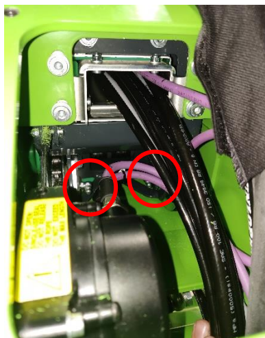
Figur 23. Smørepunkter for teleskopkjettinghjul ved den nedre og øvre enden av bomforbindelsesstykket
