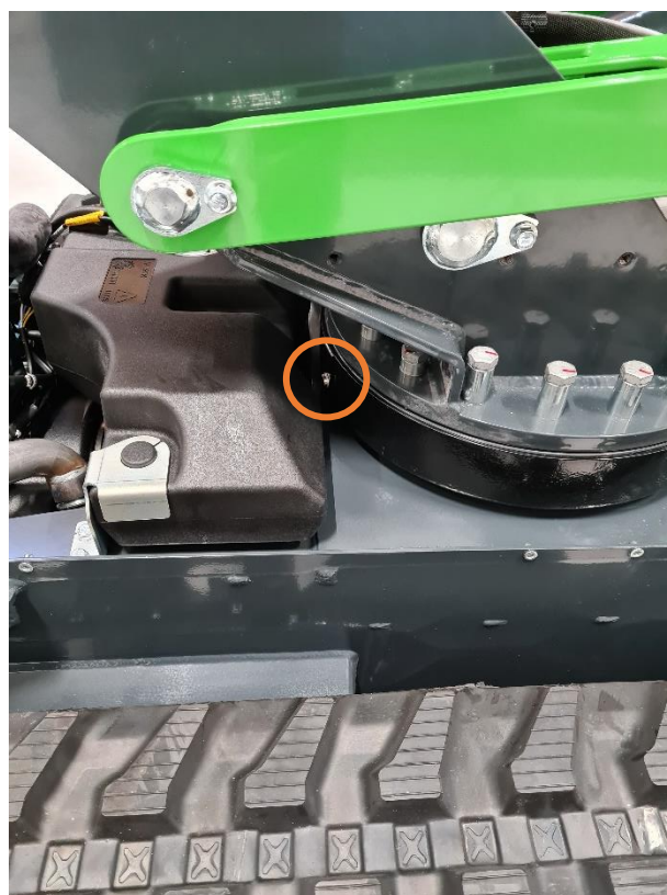
Figur 21. Trykkavlastningsskrue for dreieringens smørepunkter
