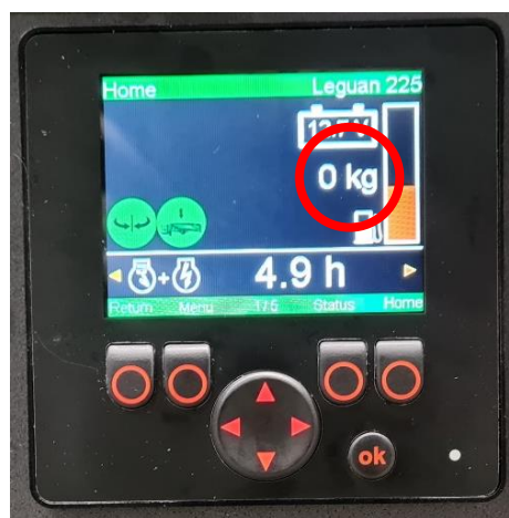
Rysunek 36. Obciążenie platformy roboczej na wyświetlaczu
