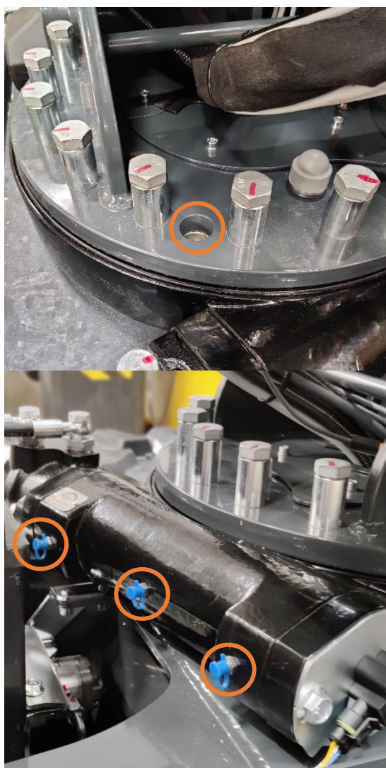
Rysunek 20. Punkty smarowania łożyska obrotu z wieńcem zębatym
