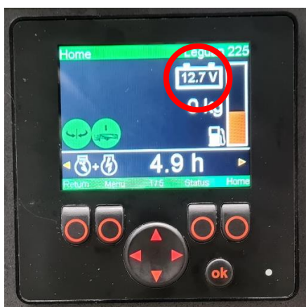
Rysunek 45. Napięcie akumulatora na wyświetlaczu
