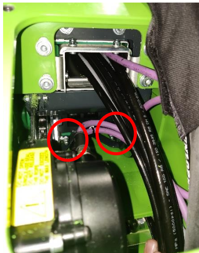
Obrázok 23. Body mazania kladky reťaze teleskopického výložníka na konci pri spoji dolného a horného výložníka
