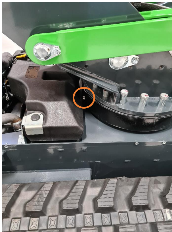
Obrázok 21. Skrutka na odľahčenie tlaku pri mazaní prstenca
