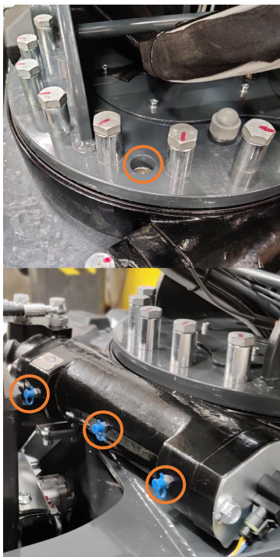
Figur 20. Smörjpunkter för svängkranslager
