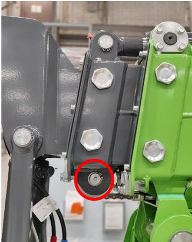
Abbildung 18. Schmierstellen für die Teleskopketten-Riemenscheibe am Ende der Arbeitsbühne
