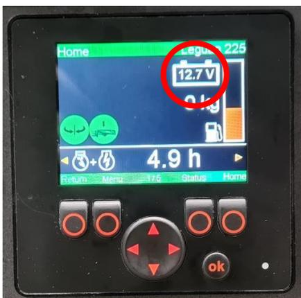
Abbildung 44. Batteriespannung auf dem Display
