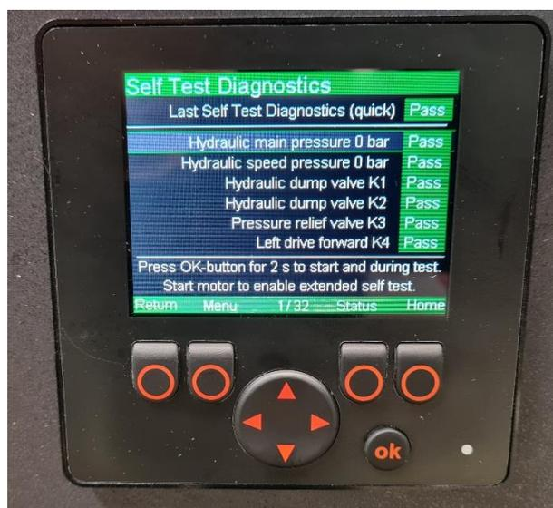
Abbildung 40. Auswahl „Selbsttest Diagnose“
