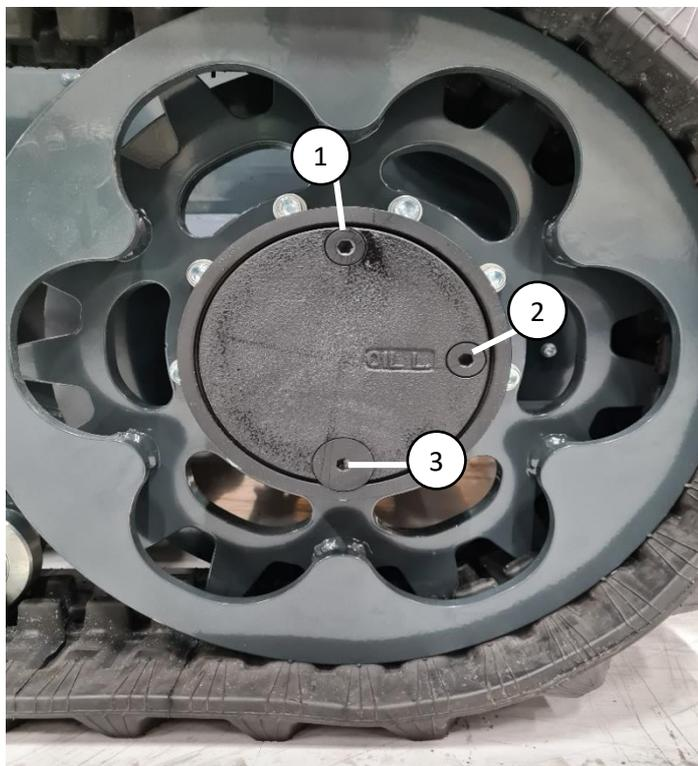
Abbildung 25. Getriebeölwechsel beim Antriebsmotor
