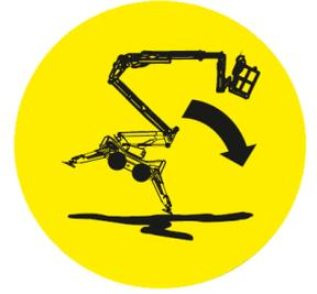
Wenn der Neigungsalarm während der Fahrfunktionen aktiviert wird, fahren Sie die Maschine auf eine ebenere Fläche.
