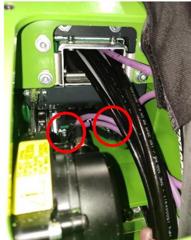
Abbildung 19. Schmierstellen für die Teleskopketten-Riemenscheiben am unteren und oberen Ende des Ausleger-Verbindungsstücks
