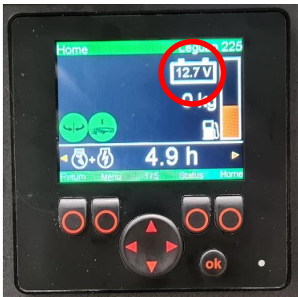
Kuva 44. Akun jännite näytöllä
