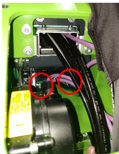
Figur 19. Smørepunkter for teleskopkjettinghjul ved den nedre og øvre enden av bomforbindelsesstykket
