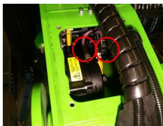
Figur 17: Smørepunkter for bladvædens remskive foran på den øvre bom.
