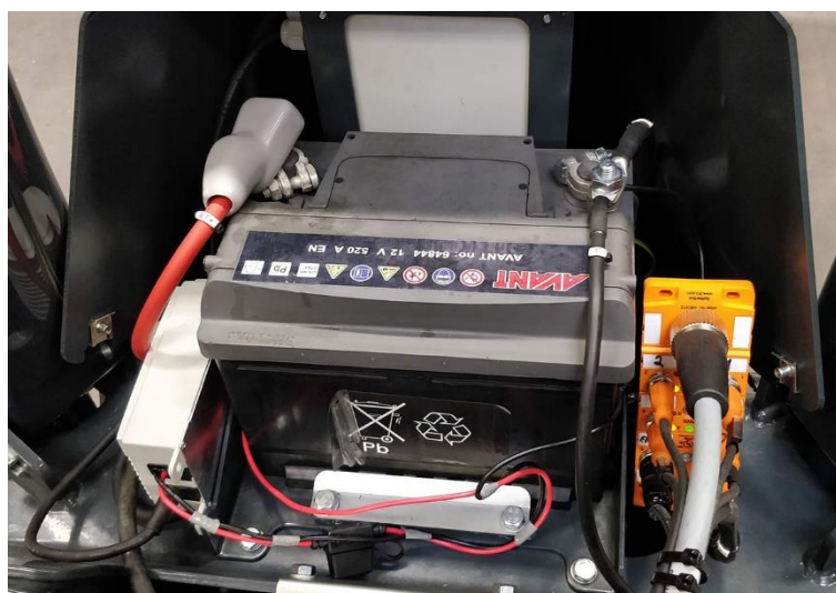
Figur 22 Batteriet er placeret på bagsiden af adgangsplatformens chassis (figur 22).
