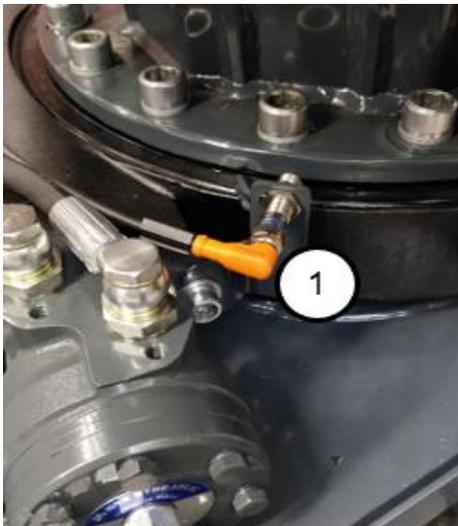
Abbildung 26 Schwenkwinkelsensor
