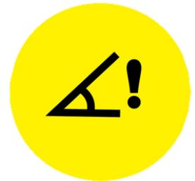
Wenn die Grenzen bei der Fahrt überschritten werden, blinkt eine orangefarbene Anzeigeleuchte und ertönt ein Warnton. Fahren Sie die Maschine auf eine ebenere Oberfläche.
