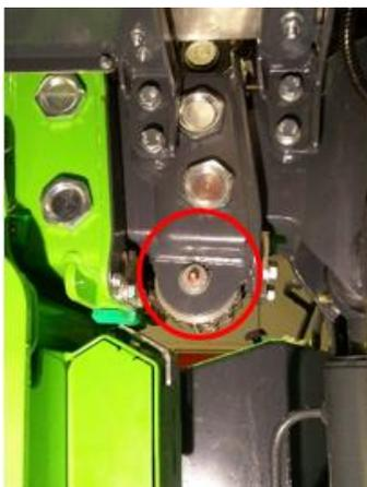
Abbildung 16 Schmiernippel für Scheibe Teleskopkette
