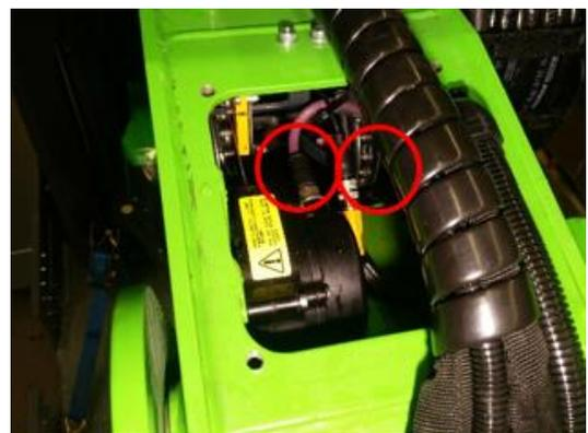
Abbildung 17: Schmierpunkte der Scheibe der Flyerkette auf dem vorderen Ende des oberen Auslegers.
