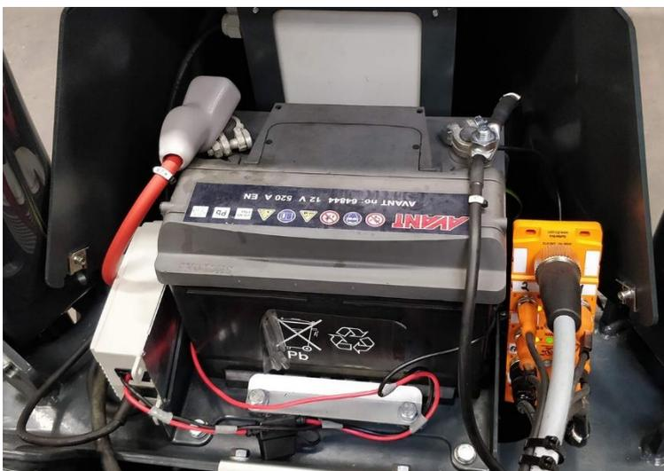
Abbildung 22 Die Batterie befindet sich hinten am Fahrgestell der Zugangsplattform.
