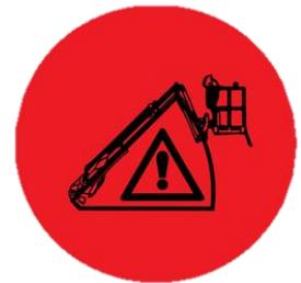
**Der Ausleger kann nicht abgesenkt werden, solange nicht der Teleskopausleger etwas eingefahren wird.**
