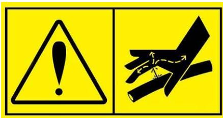
Arbeiten Sie nicht an druckbeaufschlagten Hydraulikkomponenten, da bei Versagen eines Anschlusses oder einer Komponente unter Hochdruck stehende Hydraulikflüssigkeit zum Umkippen der Maschine führen und schwere Verletzungen verursachen kann. Bedienen Sie die Maschine nicht, wenn Sie einen Fehler in der
