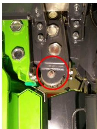
Joonis 16 Teleskoopnoole ketiratta määrdenippel
