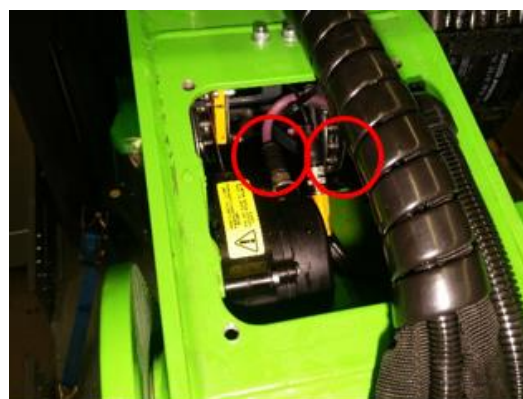
Joonis 17: Lehtketi ratta määrdepunktid ülemise noole esiosas.
