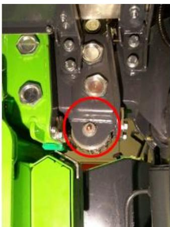
Figure 15 Buse de graissage de la poulie des chaînes télescopiques.
