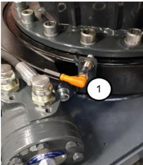
Figure 25 Capteur d'angle de pivotement
