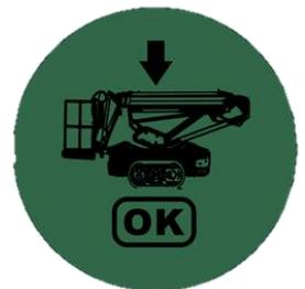
Le voyant de la position de transport du bras clignote lorsque le bras ne se trouve pas à la position de transport élevée. Cette situation est utilisée pour des obstacles hauts transversaux. La conduite est possible à une vitesse réduite. Le nivellement automatique est désactivé, mais le nivellement manuel est activé. Faire rentrer les bras à la position de transport lorsque la position élevée n'est pas requise.
