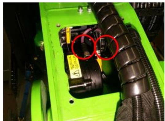
Figure 16 : Points de graissage de la poulie à chaîne à mailles jointives à l'extrémité avant du bras supérieur.
