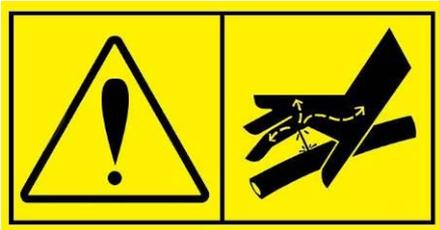
Ne jamais manipuler des composants hydrauliques sous pression car en cas de défaillance d'une fixation ou d'un élément, un vaporisateur de fluide hydraulique à haute pression peut provoquer un basculement de la machine et de graves blessures. Ne pas utiliser la machine si vous avez détecté une défaillance dans le système hydraulique.
