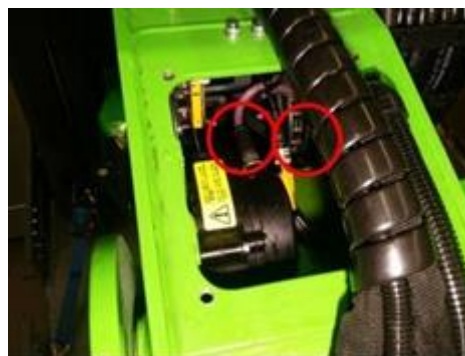
Zdjęcie 17. Punkty smarowania łańcucha w przednim końcu górnego wysięgnika.
