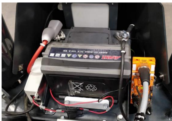
Zdjęcie 22. Akumulator znajduje się w tylnej części podwozia.
