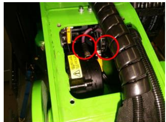
Afbeelding 17: Smeerpunten van de schalmkettingschijf aan de voorkant van de bovenste arm.
