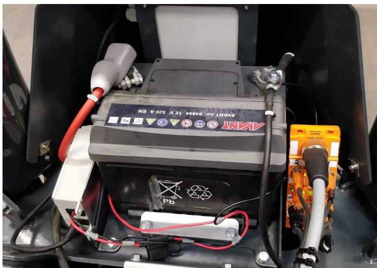
Afbeelding 22 De accu zit in de achterkant van het chassis
