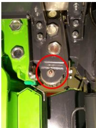
Afbeelding 16 Smeernippel telescopische kettingschijf
