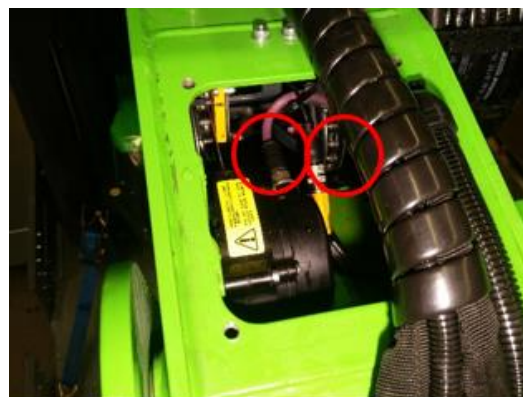
Obr. 12: Mazacie body remenice reťazena prednom konci horného výložníka.
