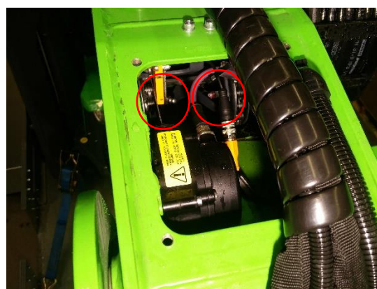
Obr.17: Mastiace body remeníc listových reťazí na prednej strane 2. ramena
