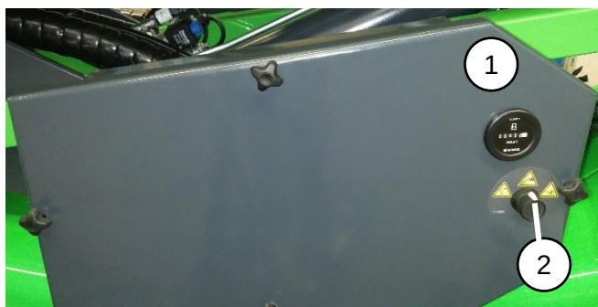
Obr.9: Núdzové spúšťanie na úrovni zeme
