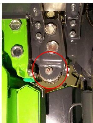
Obr.16: Maznice remeníc reťazí teleskopu
