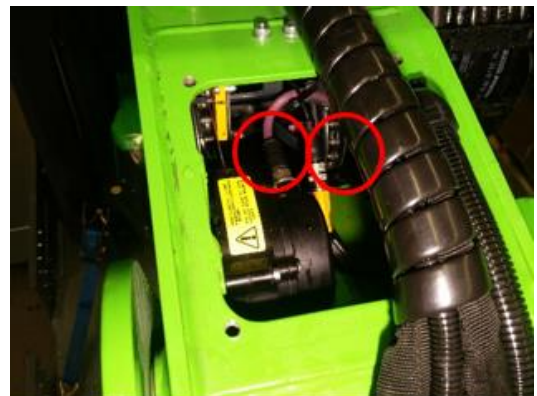
Illustration 16: Smörjpunkter till flyerkedjans kedjehjul på överbommens framsida.
