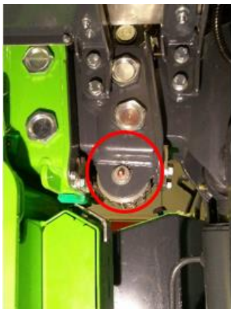
Illustration 17 Smörjnippel för kedjehjul för teleskopering
