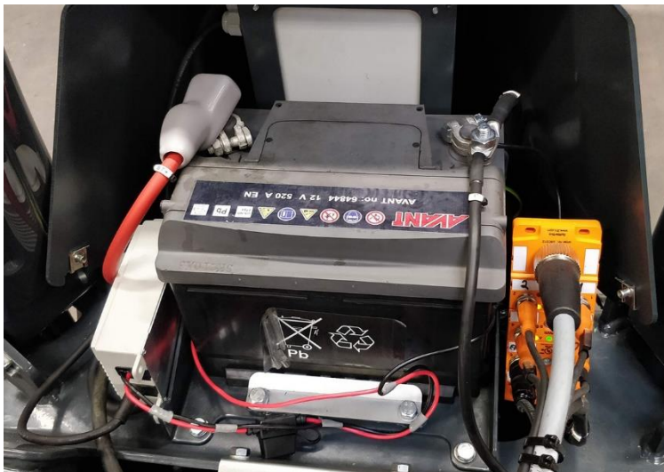
Illustration 22 Batteriet är placerat på baksidan av chassit
